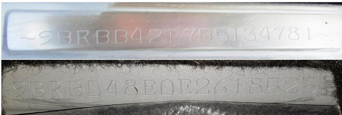
Figura 5. Denotativa dos sequenciais alfa-numéricos dos chassis: superior - veículo examinado, inferior - veículo de referência.
