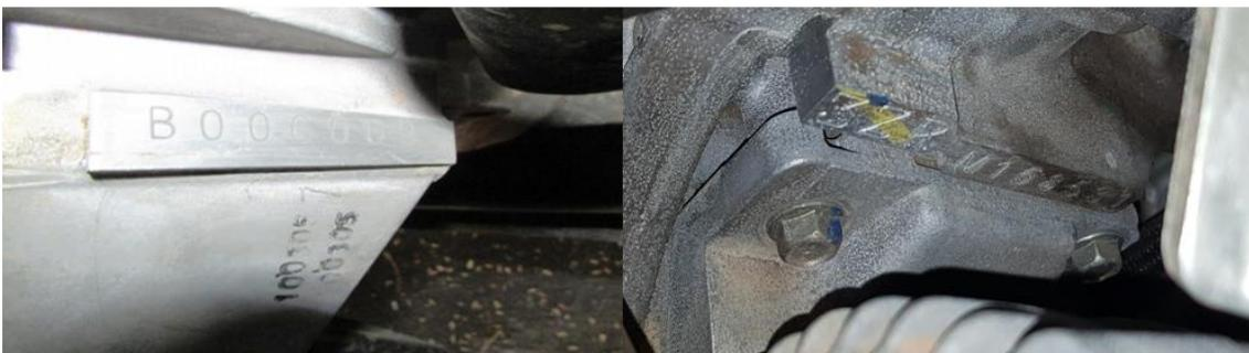
Figura 4. Referencial à discrepância de localização das numerações de motor: esquerda - veículo examinado, direita - veículo de referência.
