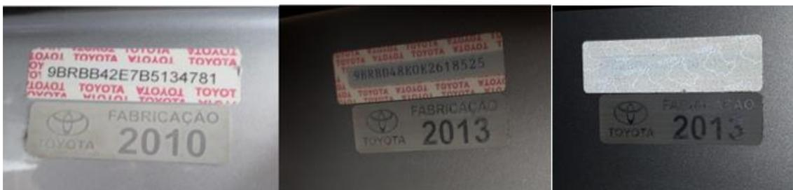
Figura 3. Correlata às etiquetas adesivas auto-destrutíveis, onde: esquerda - veículo examinado, central - veículo de referência, e direita - holografia constatada neste.
