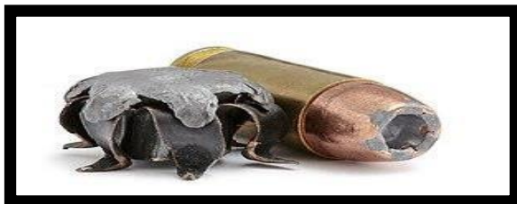
Figura 1 – Projétil de ponta oca após o uso e o mesmo projétil intacto
