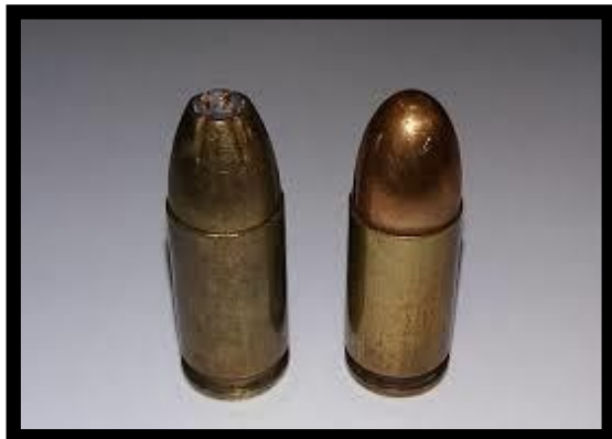
Figura 2 – Cartucho de arma de fogo com projétil ponta oca (maior poder de parada) e ogival (maior poder de penetração e perforante)
